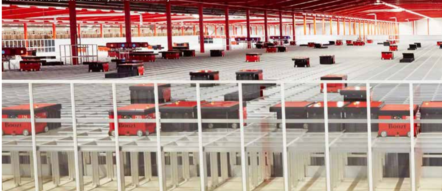
Boozts AutoStore-anläggning i E-city Engelholm om totalt 500 robotar och 500 000 förvaringslådor för hantering av e-handelsbeställningar.
